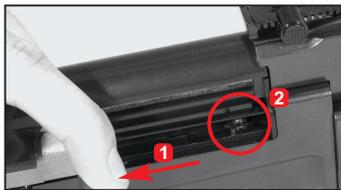
Para ajustar o hop up puxe para trás a alavanca de manejo (1) e segure-a, então desloque a alavanca interna (2) para frente ou para trás conforme necessidade de regulagem para otimizar o seu tiro, de acordo com o peso da bolinha, distância e condições meteorológicas;
