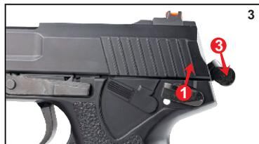
Após terminar de efetuar os disparos, coloque o equipamento na posição travado, para isso engatilhe a pistola empurrando o cão (3) para baixo e acione a trava de segurança (1), dessa forma poderá manusear o equipamento com segurança.
